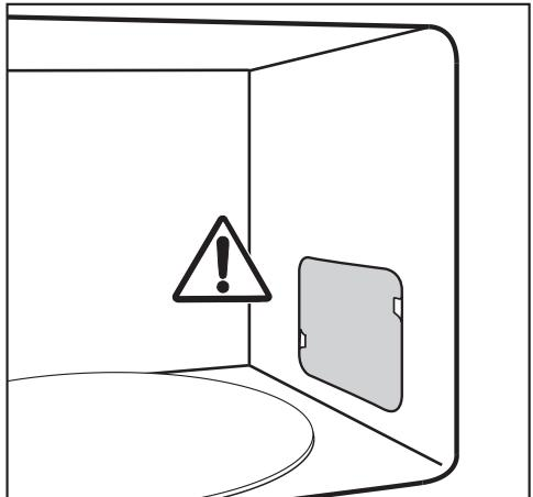
Не удаляйте специальную защитную пластины, расположенные в рабочей камере перед отверстием выхода микроволн, а также плёнку с внутренней стороны дверцы.
