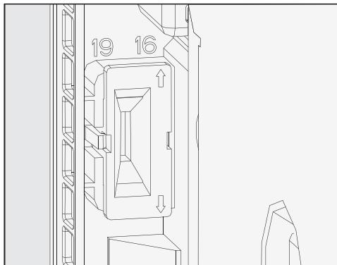
■ Вставьте адаптер так, чтобы стрелка указывала на подходящий размер толщины стенок.
