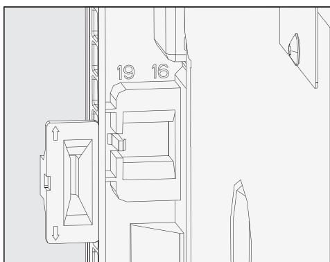
■ Обратите внимание на оба размера толщины стенок, которые видны в рамке с обратной стороны прибора.
